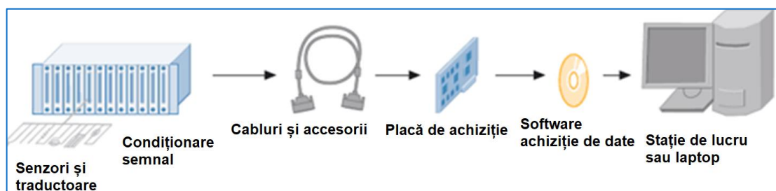
Fig. 4.5. Lanț de achiziție date (Sistem National Instruments) [15]
