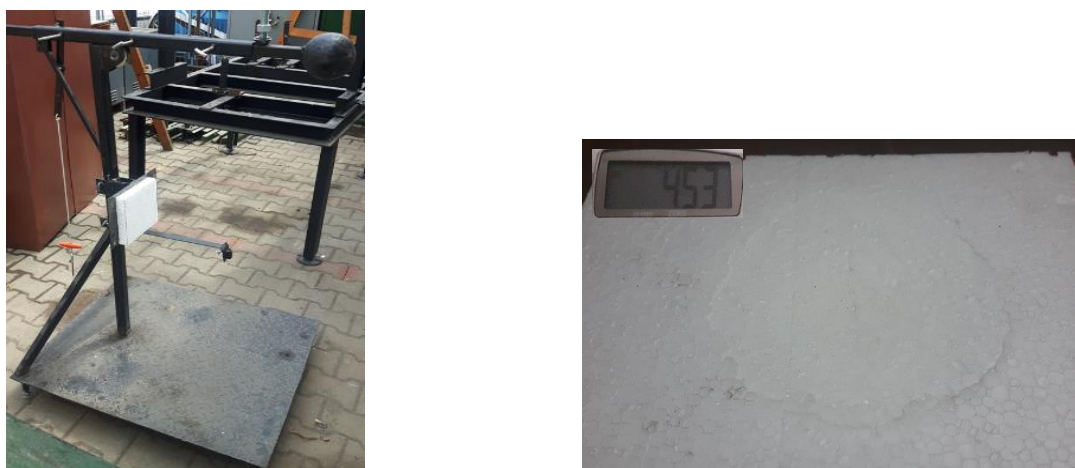
Figura 1.6. Identificarea experimentală a degradării materialului EPS produsă la impact
