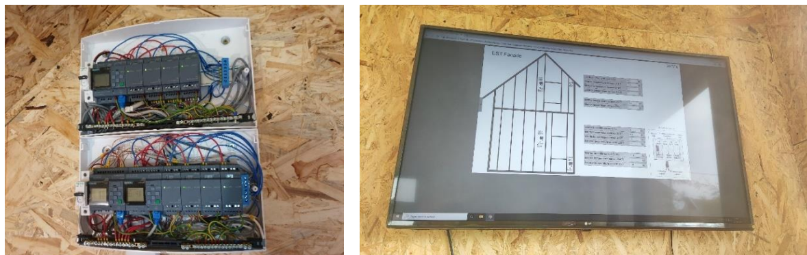
Fig. 3.12. Sistem achiziție (Logo 8!) și display-ul sistemului SCADA
