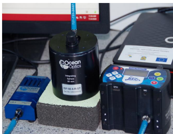
Figura 2.4. Foto: Stand experimental pentru studiul reflectanței spectrale (a) și pentru studiul comportamentului termic al bucăților de sticlă celulară funcționalizată (b)
